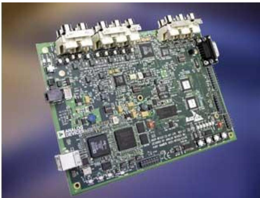
Figura 28. Tarjeta de Desarrollo *ADSP-BF533 EZ-Kit Lite®* de *Analog Devices* [21].
