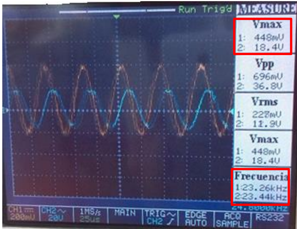
Figura 39. Prueba de funcionamiento del circuito con onda sinusoidal.
