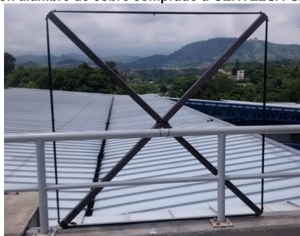
Figura 41. Foto antena receptora de VLF instalada en el Observatorio de Astronomía de la UTP, construida con alambre de cobre comprado a CENTELSA ©.
