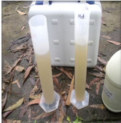
Figura 42: Salida Humedal Convencional y Modificado. Segunda Etapa.
