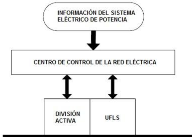
Figura 7. Diagrama del esquema de seguridad basado en la división activa y control de frecuencia de carga (Deslaste de Carga).
