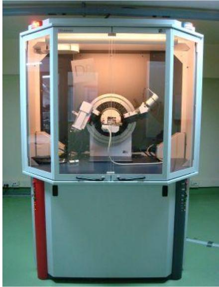
Figura 13. Difractómetro de rayos X Bruker D8 Advance.
