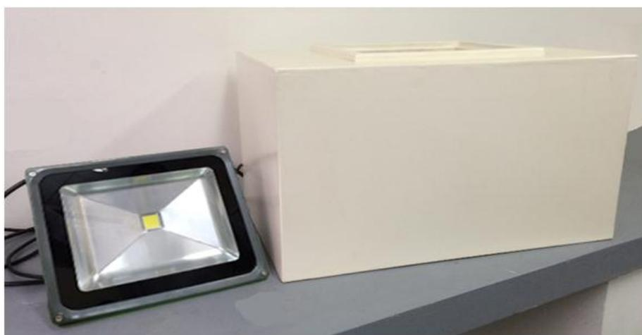
Figura 18. Reactor fotocatalítico construido y lámpara utilizada en la reacción de degradación del naranja de metilo.
