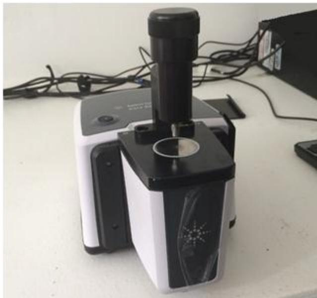
Figura 14. Espectrómetro FT-IR Cary 360.
