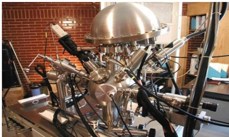
Figura 15. Espectrofotómetro VG-Microtech Multilab ESCA2000.
