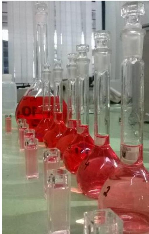
Figura 21. Patrones preparados para la curva de calibración del naranja de metilo a pH=2,5.
