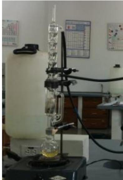
**Figura 23.** Equipo de extracción Soxhlet
