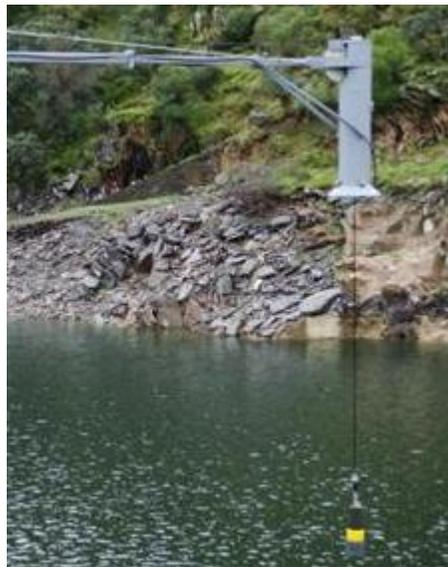
**Figura 9.** Muestreo automático de agua [24].
