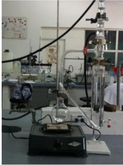
**Figura 22.** Equipo de extracción líquido- líquido continuo
