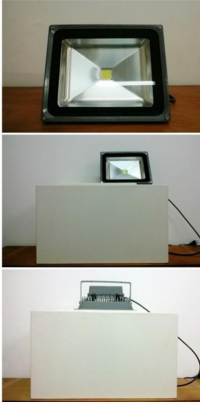
Figura 18. Reactor fotocatalítico de luz visible con lámpara LED
