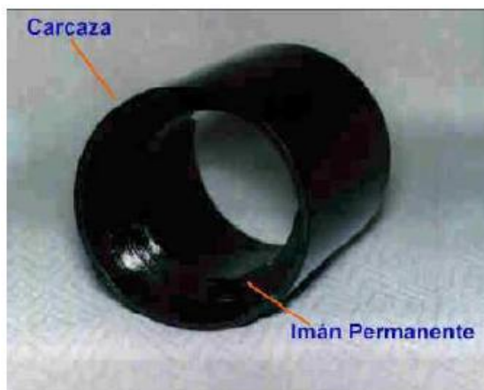
Figura 12 Partes del estator, motor dc
