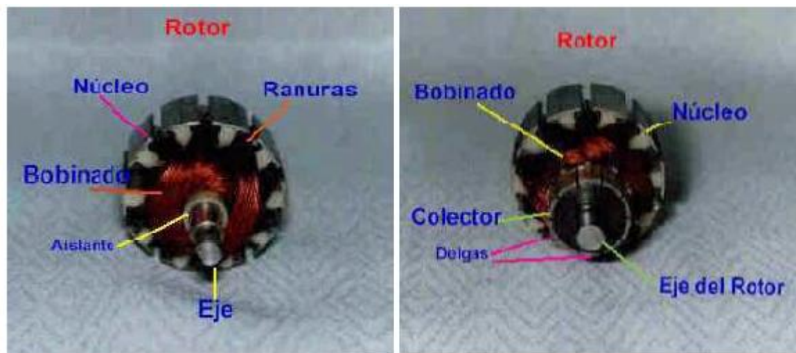
Figura 11 Partes del rotor, motor dc
