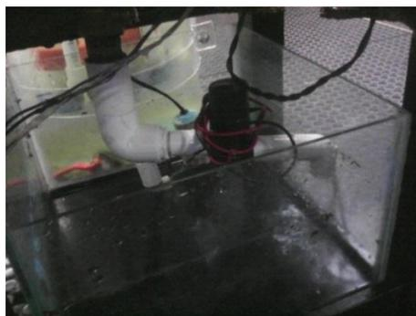
Se conectó una reducción 1" a 1/2" al tubo de entrada del medidor de caudal y al tubo de salida del tanque, pues el orificio de salida del tanque mide 1" de diámetro mientras que el orificio de entrada del medidor de caudal mide 1/2" de diámetro.
