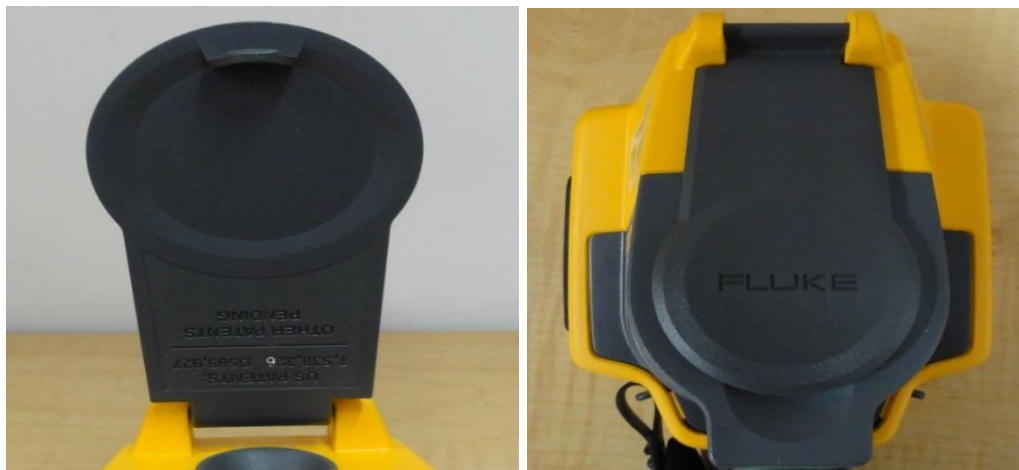
Figura 10. Tapa del lente de la cámara térmica Fluke TI32
