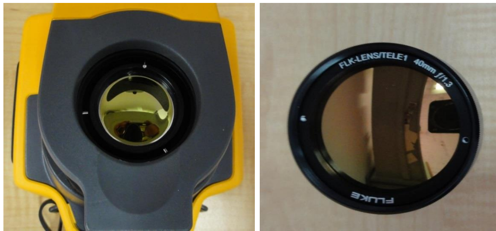
Figura 9. Lentes de la cámara térmica Fluke TI32
