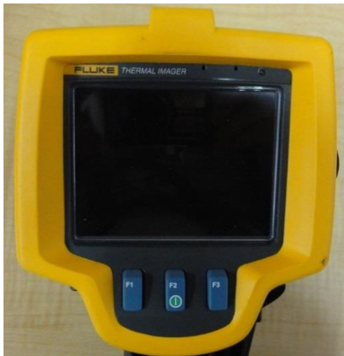
Figura 11. Pantalla de la cámara térmica Fluke TI32
