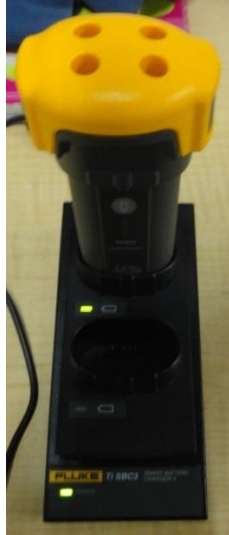
Figura 17. Base de la cámara térmica Fluke TI32
