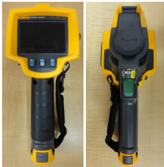
Figura 8. Cámara térmica Fluke TI32
