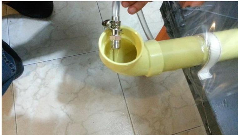
En la figura 2 se observa un recipiente donde se almacena el agua para la circulación del agua, dentro del recipiente está sumergida la bomba que hace circular la solución nutritiva para alimentar las plantas.
