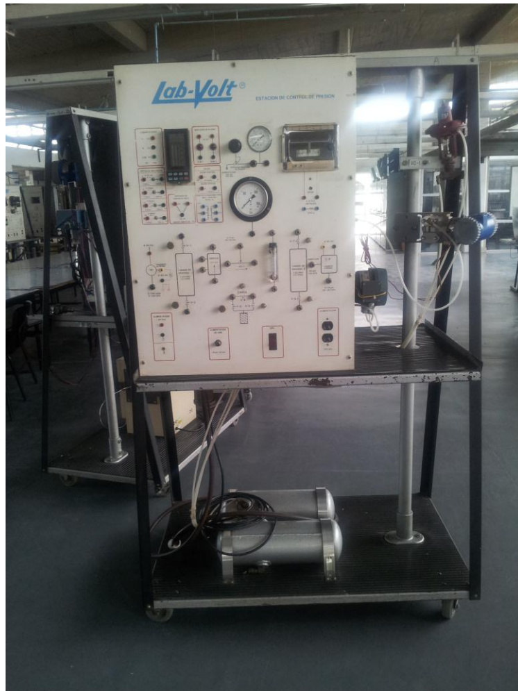
Figura 56. Estación de control de presión de aire comprimido.
