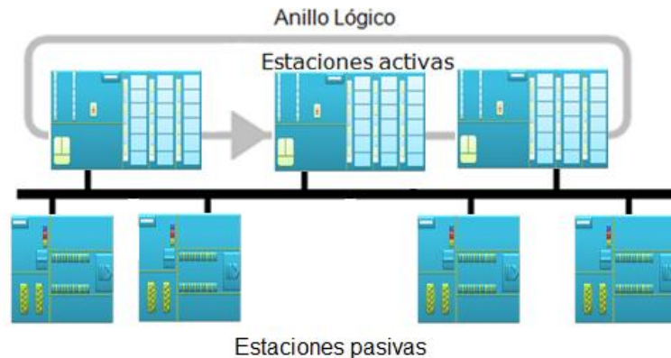
Figura 11. Anillo lógico de paso de testigo.
