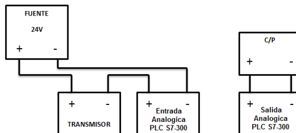
Figura 58. Diagrama eléctrico de la estación de control de presión.
