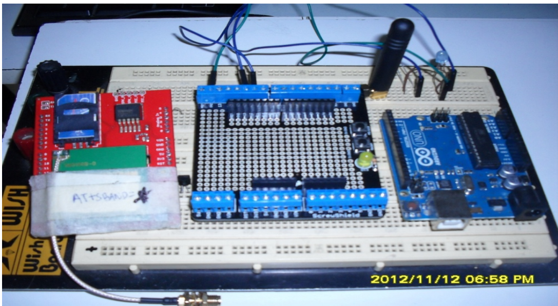
Figura 42. Conexión a borneras
