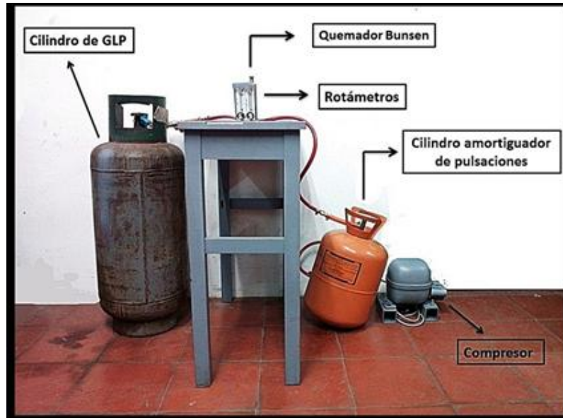
Figura 10. Vista frontal del banco de prueba puesto a punto
