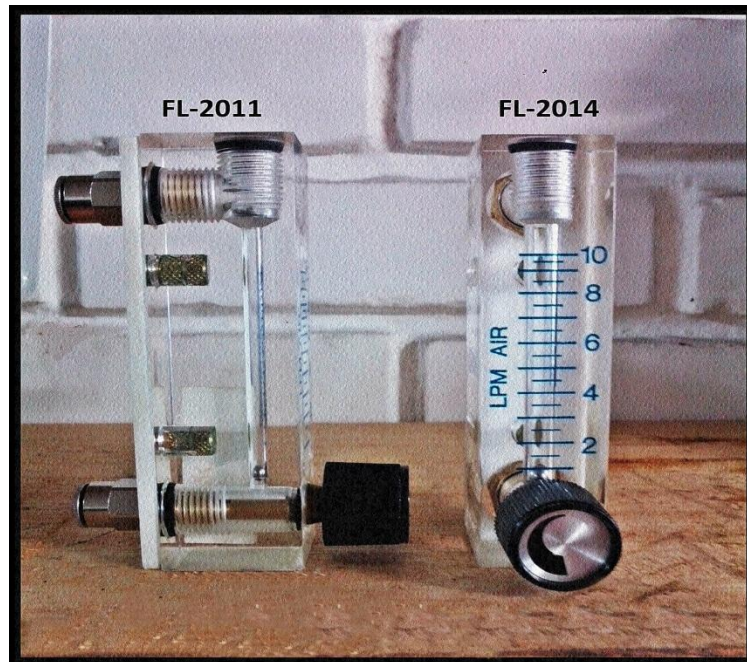
Figura 9. Vista frontal y lateral de los rotámetros utilizados
