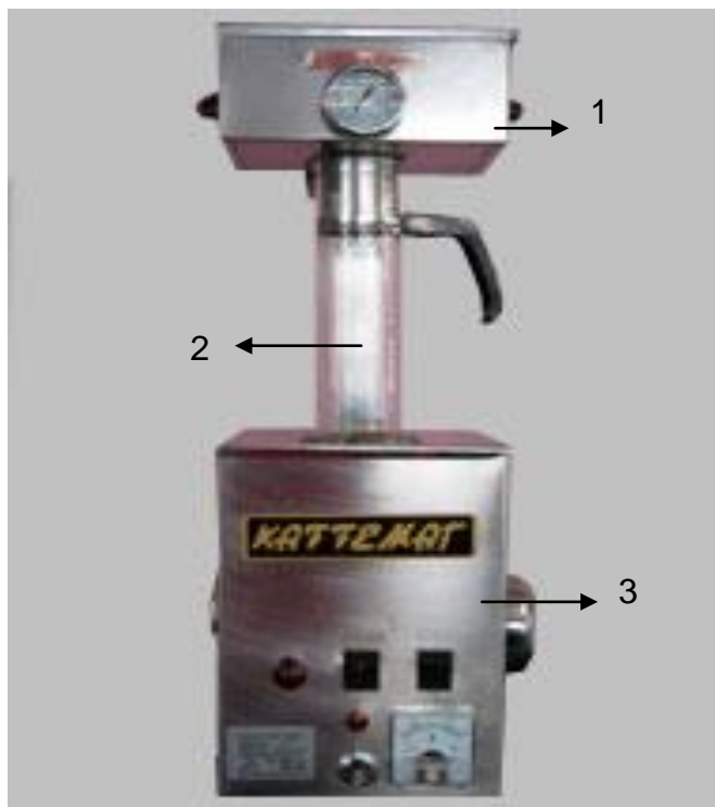
Figura 1. Tostadora kaffemat en lecho fluido
