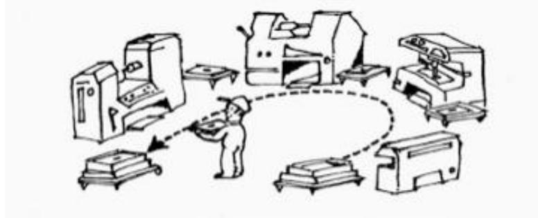
Figura 1.3: Celda de grupo de máquinas con manejo semi-integrado de materiales [6]
