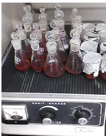
Figura 18. Mezcla de muestra con solución extractora compuesta por hexano, acetona y diclorometano.
