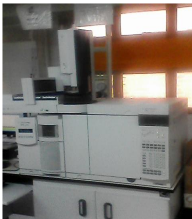
Figura 21. Cromatógrafo de gases (GC) Agilent Technologies 7890A acoplado a espectrómetro de masas cuadrupolo Agilent Technologies 5975C
