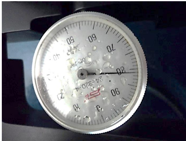
Figura 27. Lectura de desviación del dial ubicado en el generador
