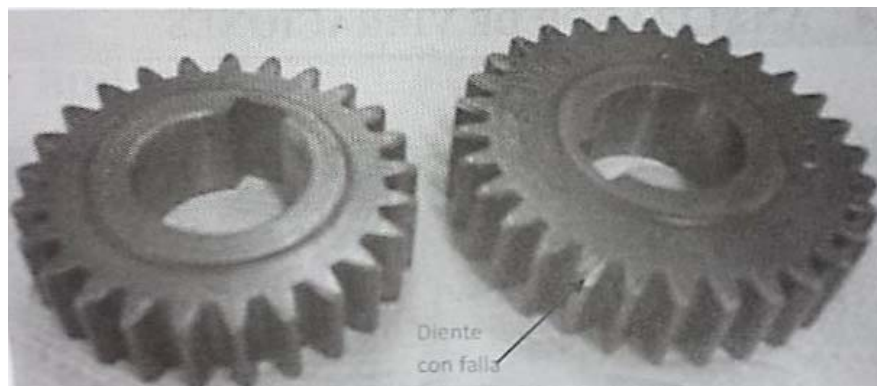
Figura 9. Juegos de ruedas dentadas con falla en un diente
