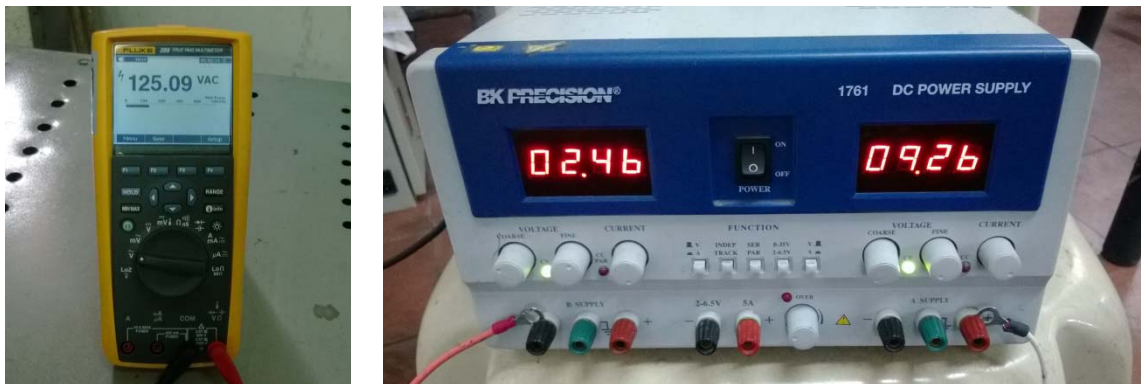
Figura 51. Ajuste de la tensión generada por medio del voltaje dc de excitación
