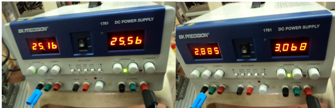
Figura 49. Medición de voltaje y corriente de la fuente de excitación
