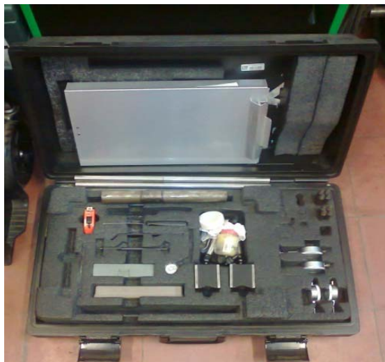
Figura 30. Equipo completo de alineación
