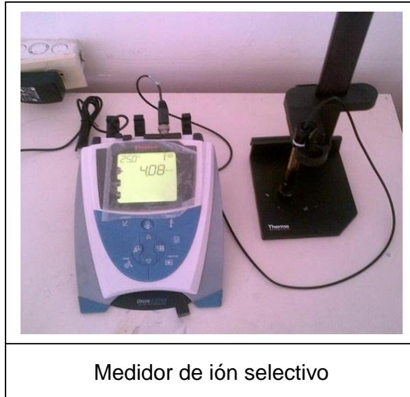
**Figura 9.** Equipo para cuantificar fluoruros por ISE
