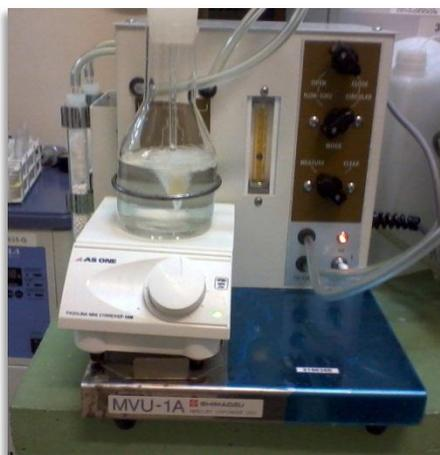
**Figura 6.** Unidad vaporizadora de mercurio SHIMADZU MVU-1A
