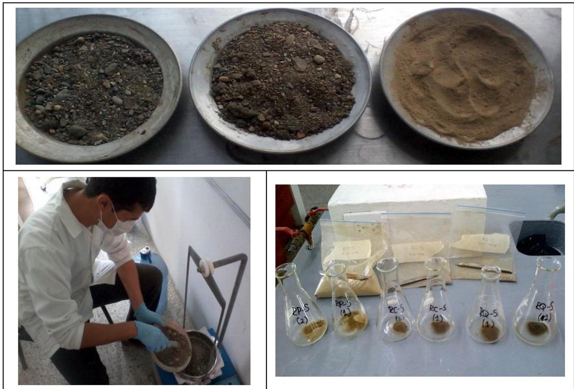
**Figura 20.** Ilustración de Secado, tamizado y preservación de sedimentos.
