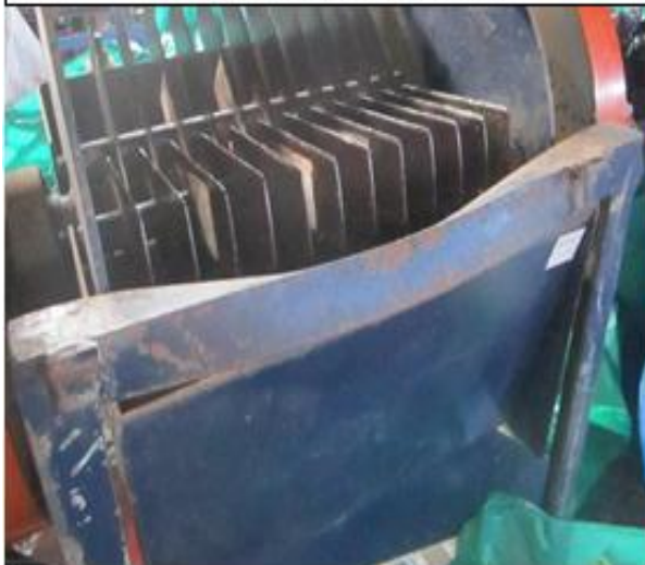
PERFIL LATERAL DEFORMADO
