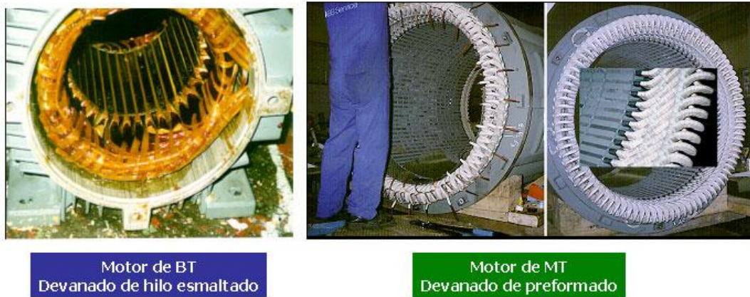
Figura 10 Devanados de un motor de inducción
