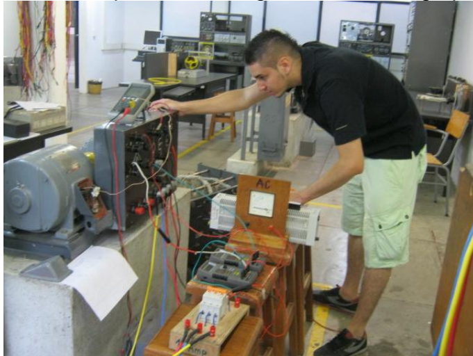
Figura 14. Realización de la prueba sin carga del motor del grupo 4.
