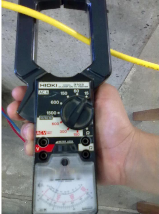
Figura 9. Corriente de alimentación utilizando la pinza voltiamperimétrica.
