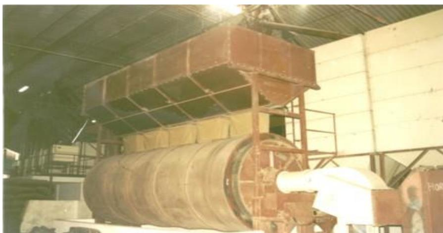
**Figura 2.2. Secador Rotativo Tipo Guardiola**
