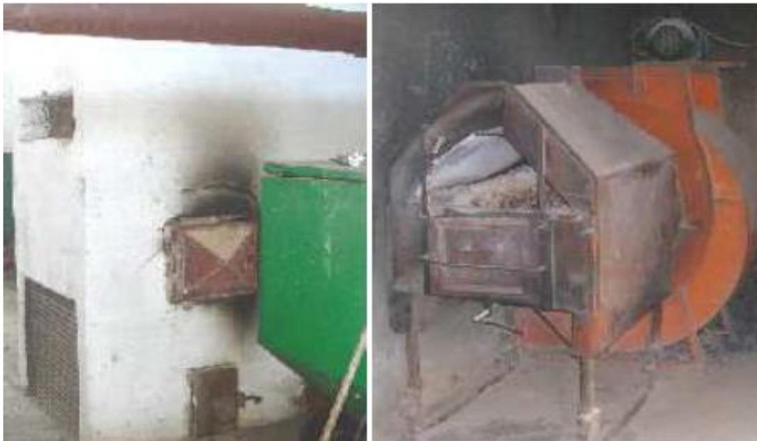
**Figura 2.9. Intercambiadores de calor artesanales**
