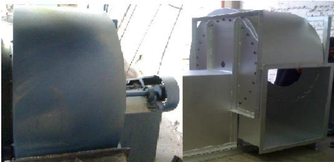
**Figura 2.13 Ventiladores centrífugos industriales**
