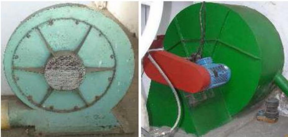
**Figura 2.14 Ventiladores centrífugos artesanales**
