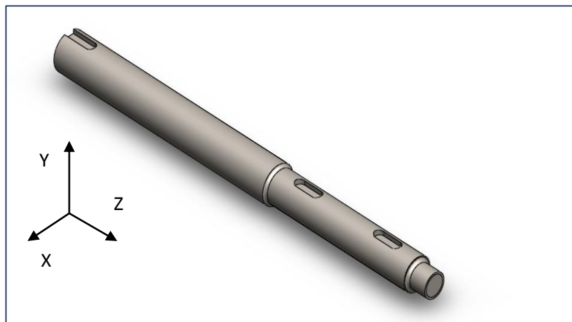
Figura 3. Coordenadas para el eje del banco de pruebas de rotor en voladizo
