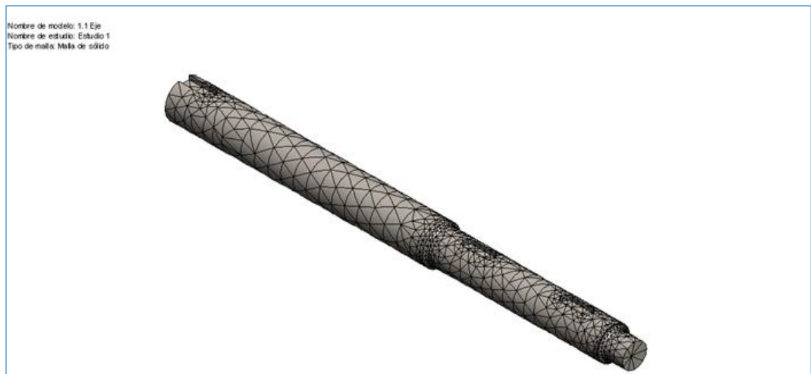
Figura 12. Mallado del cuerpo
