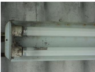
**Figura 21. Lámpara con tubos diferentes (T-8 y T-12)**
