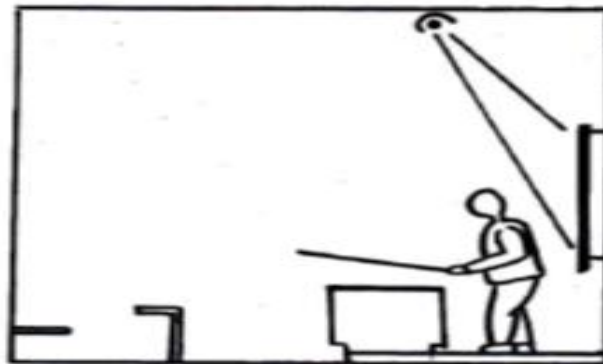
Figura 9. Alumbrado adicional sobre el tablero.
