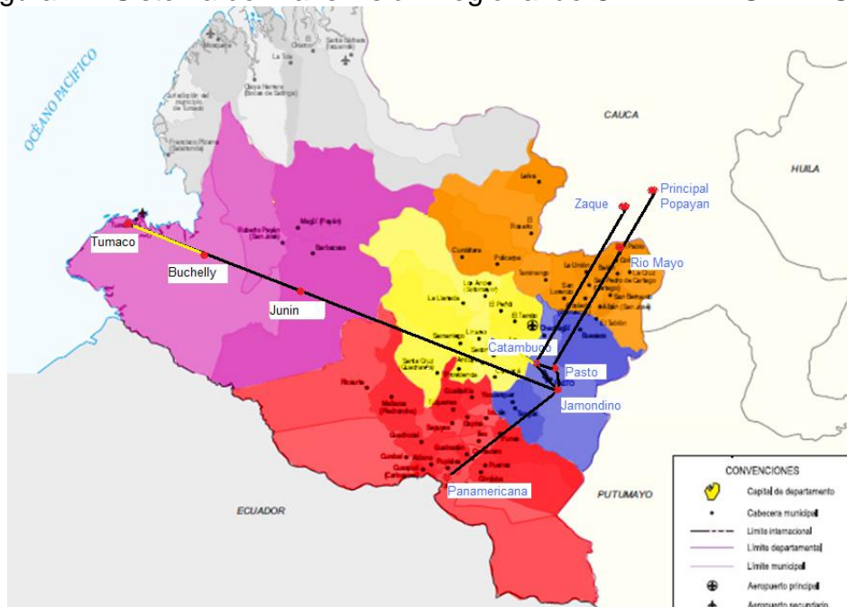
Figura 11. Sistema de Transmisión Regional de CEDENAR S.A. E.S.P.
