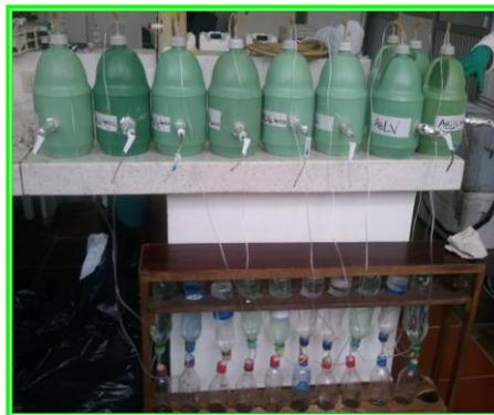
**Figura 17. Montaje Anaerobio**
