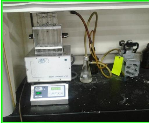
**Figura 26. Digestor nitrógeno Kjeldahl**
