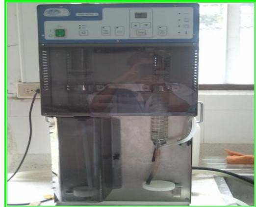
**Figura 27. Destilador nitrógeno**
