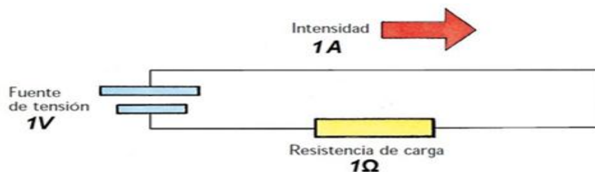
Figura 5. Solución circuito eléctrico
