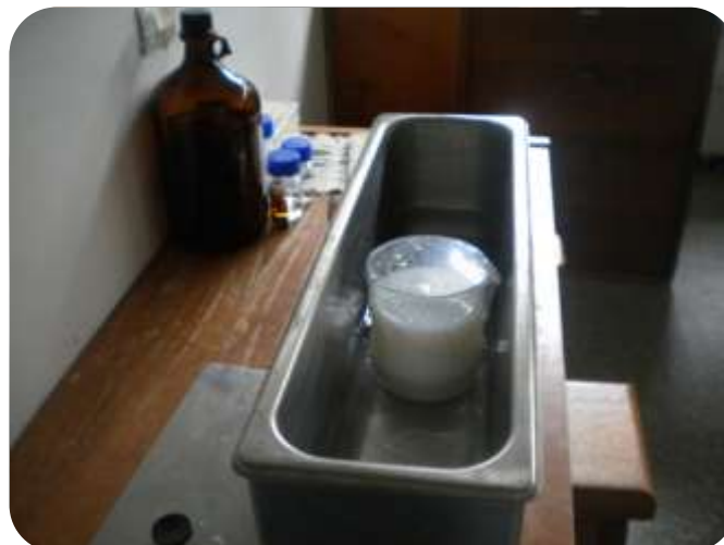
Figura 7. Montaje para suspensión coloidal de \text{TiO}_2 en ultrasonido.
