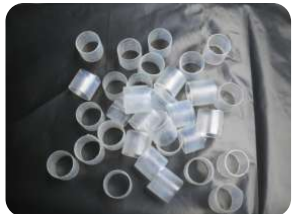
Figura 9. Vidrio soportado con \text{TiO}_2
