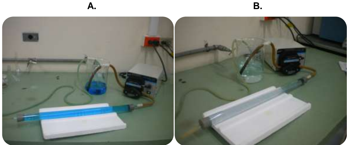
Figura 12. Montaje Reactor solar tubular empaquetado con vidrio soportado con \text{TiO}_2 antes (A) y después (B) de la degradación.
