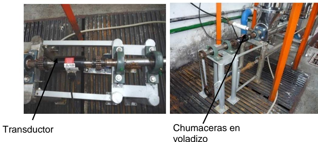
**Figura 29.** Unidad de visualización del transductor óptico E200-ORT-12.
