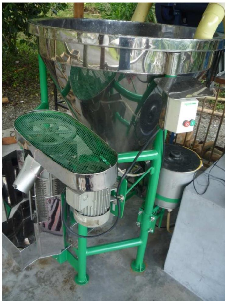
Para disminuir los costos de fabricación de la tecnología ECOMILL®, se propone inicialmente para el módulo ECOMILL® 500 otra alternativa para el material de construcción del depósito de almacenamiento de café que brinde una ventaja sobre el método actual. Esta opción consiste en la fabricación del tanque de
