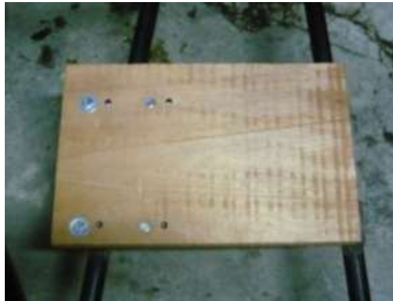
Figura 76. Base de madera para acomodar el motor
