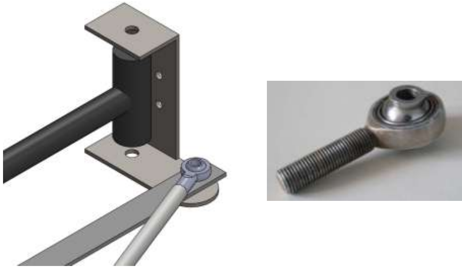
Figura 71. Unión de la palanca de mando por medio de la rótula
