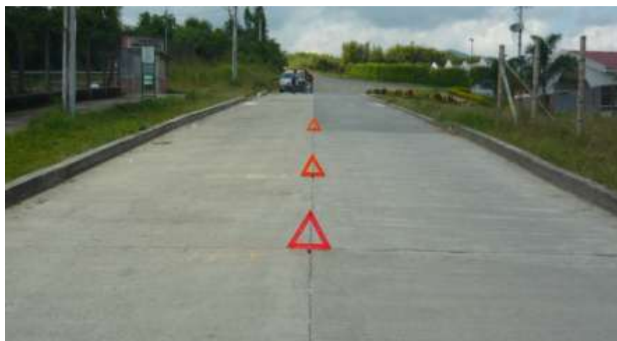
Figura 79. Disposición de los conos, prueba de frenado y maniobrabilidad
