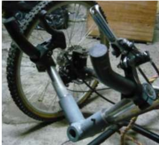
Figura 74. Montaje de la palanca de frenos y de la palanca del acelerador
