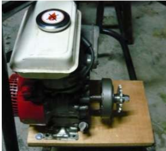
Figura 77. Montaje del motor a la base de madera y a la estructura
