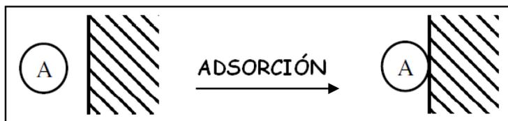
**Figura 25. Ilustración del fenómeno de adsorción.** [27]
