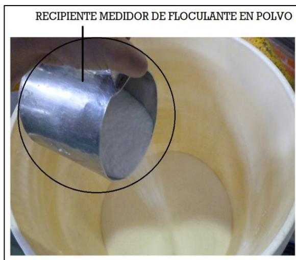
**Figura 35. Recipiente medidor de floculante en polvo del Ingenio Riopaila.**
