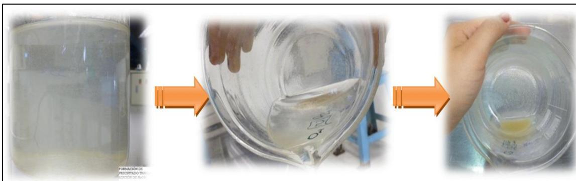
**Figura 30. Precipitado de hidróxidos metálicos ocasionado por la adición de soda cáustica a muestra de agua cargada iónicamente.**
