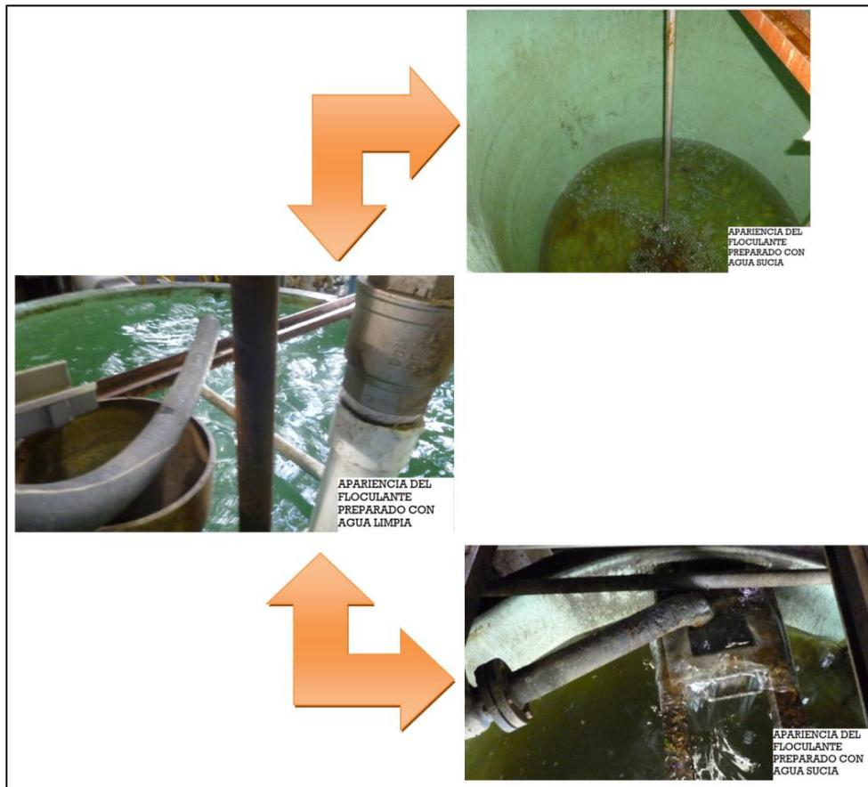
**Figura 32. Diferencia entre un floculante preparado con agua limpia, y uno preparado con agua sucia.**
