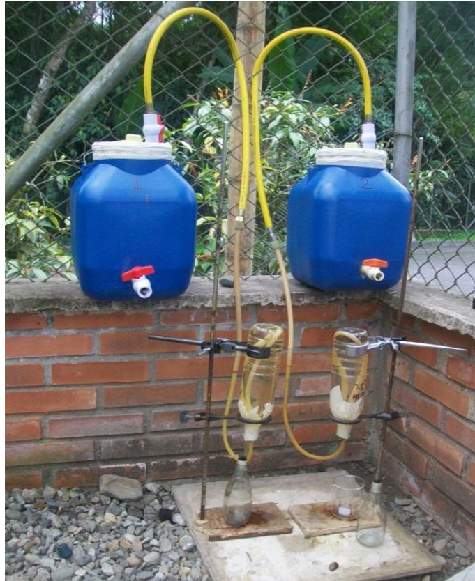
Figura No 13 Digestores Anaerobios Fuente: Propia
