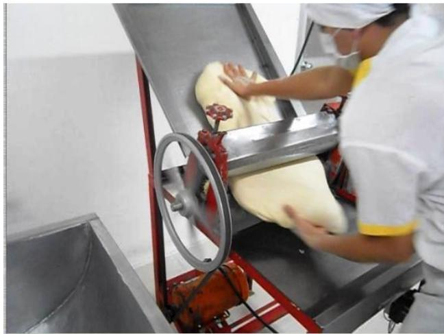
Figura 3. Fase 2 proceso de aplanado y corte
