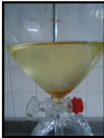
**Figura 30.** Separación del biodiesel (fase superior) y la glicerina (fase inferior).
