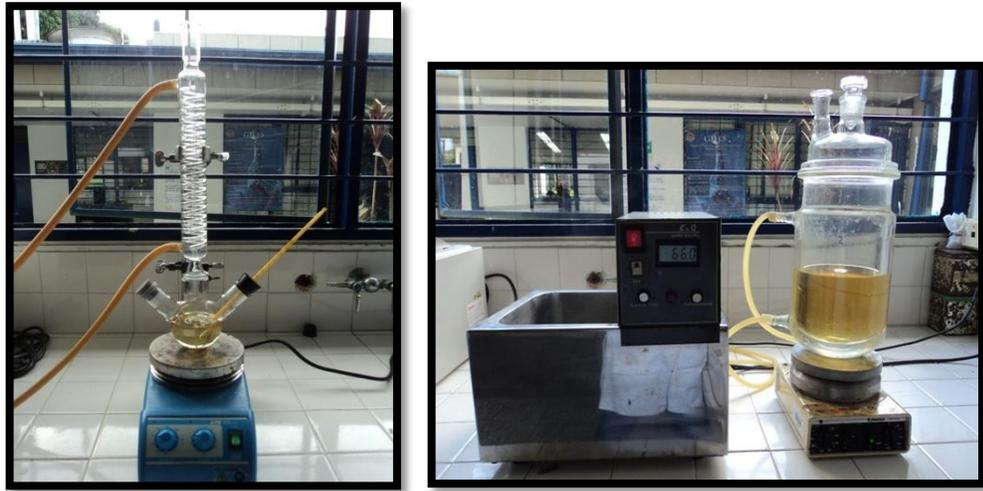
**Figura 29.** Reactores empleados para la reacción de transesterificación.
