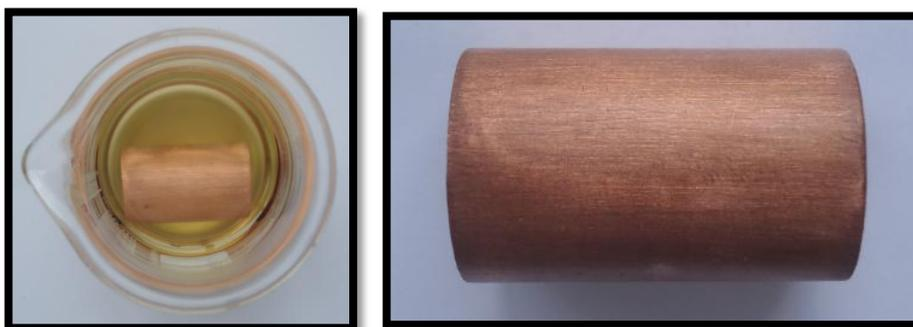
**Figura 37.** Lámina de cobre sometida a la prueba de corrosión.
