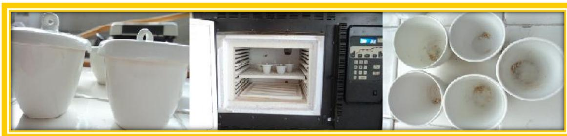
**Figura 29.** Determinación de cenizas
