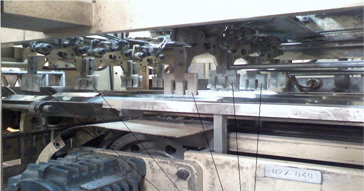
DEDOS NEUMATICOS PARA SOSTENER LOS ROLLOS ACEPTADOS
