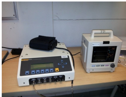
Figura 13. Conexión del adaptador tipo T entre la manguera que conecta el brazalete y el monitor
