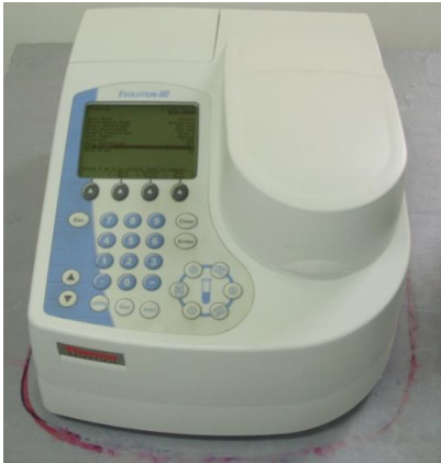
Figura N° 22. Espectrofotómetro UV-Visible, modelo Evolution 60 marca Thermo Spectronic USA cat 840-189600.
