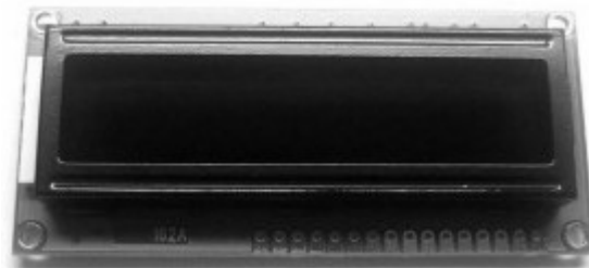
Figura 3.15. Display de cristal liquido LCD. [14]
