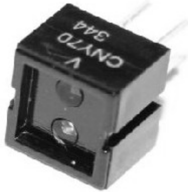
Figura 5.17. Sensor de objetos CNY70.
