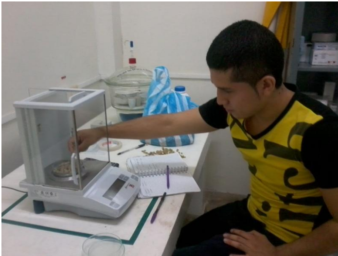
Figura 6. Como no pesar una muestra.
