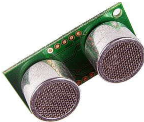
Figura 16. Sensor ultrasónico SRF05 DEVATECH.
