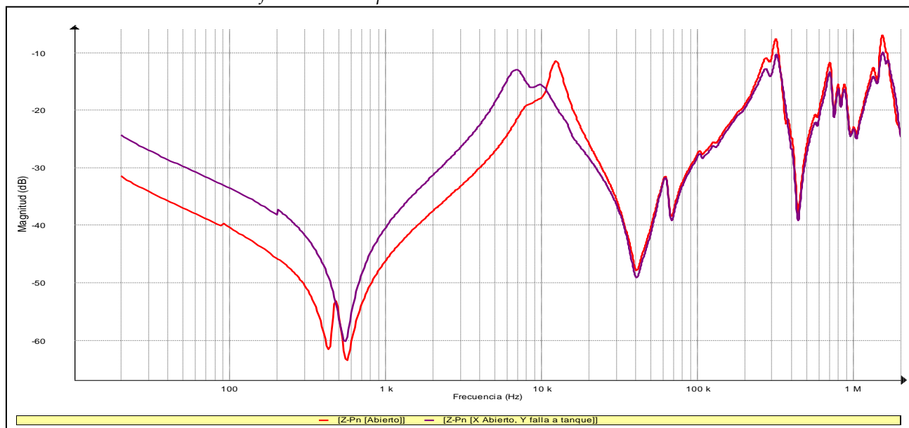
Figura No. 60. Huellas obtenidas a partir del Análisis del Barrido de la Respuesta en Frecuencia de las mediciones efectuadas en la prueba 1 – Admitancia de circuito abierto BT.
