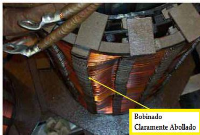
Figura No. 34. Transformador con deformación en el bobinado
