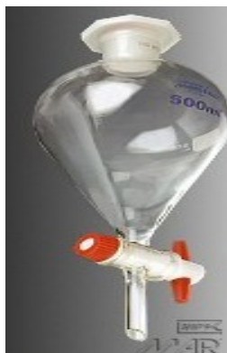
Figura 16. Imagen de embudo para extracción líquido-líquido
