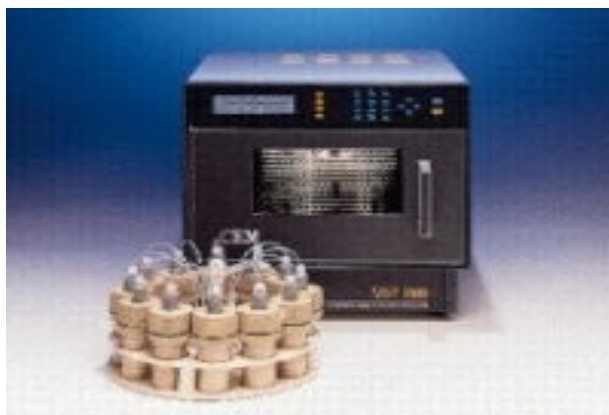
Figura 18. Sistema de extracción asistida por microondas MSP-1000
