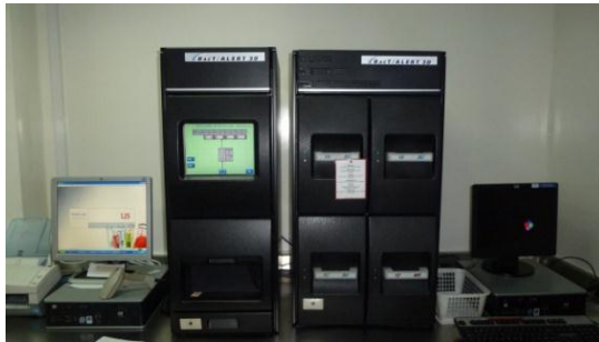
Fig. 6 Sistema de detección Bact/ALERT en el que se incuban las botellas de hemocultivos en el Laboratorio de Microbiología del Hospital Universitario San Jorge.
