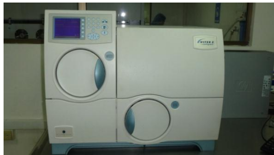
Fig. 7 Sistema Vitek 2 que permite la tipificación de un germen en una muestra purificada, foto original, tomada en instalaciones del Laboratorio de Microbiología del Hospital Universitario San Jorge.
