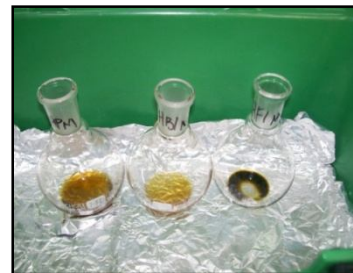
Figura 38. Residuo de HTP en proceso de cuantificación (Fuente: Elaboración propia)
