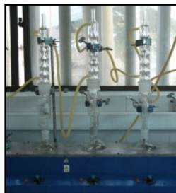
Figura 37. Equipo Soxleth -cuantificación de HTP (Fuente: Elaboración propia)
