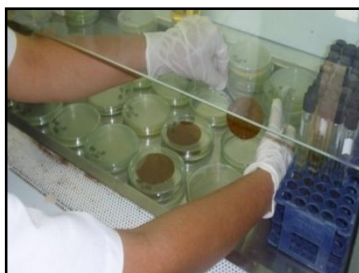
Figura 47. Siembra de microorganismos degradadores de HTP (Fuente: Elaboración propia)
