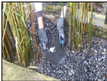
Figura 45. Toma de muestra para análisis microbiológico HSSP (Fuente: Elaboración propia)
