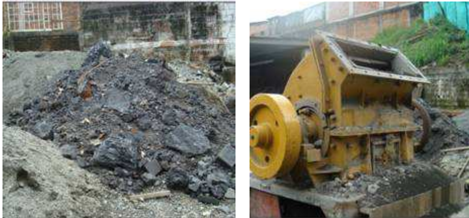
Ilustración 10 Escoria para triturar y máquina trituradora
