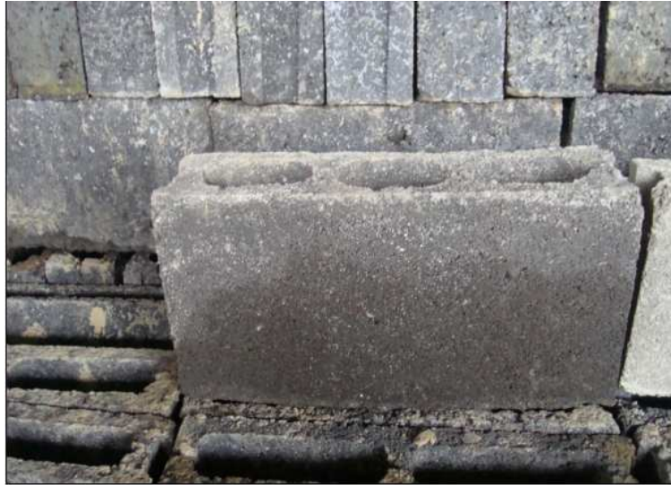
Ilustración 13 Producto final - Bloques de cemento
