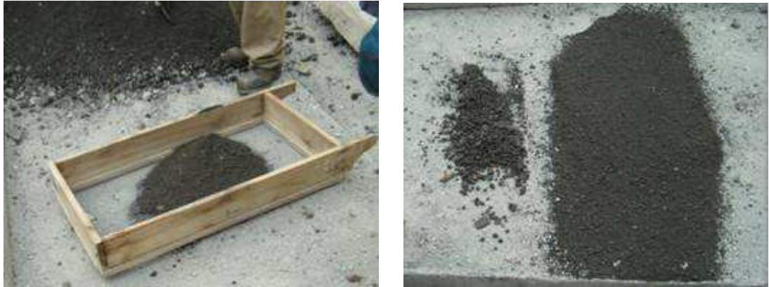
Ilustración 12 Separación de ferrosos y producto final (gravilla y arena)
