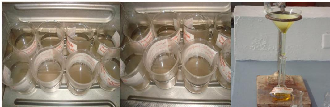
**Figura 11:** Digestión ácida y posterior filtración de las muestras de agua analizadas (*Fuente: Los autores*).
