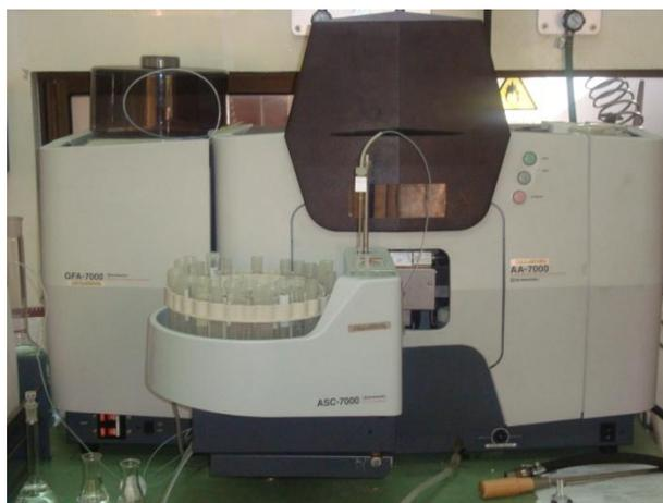
**Figura 14:** Equipo de absorción atómica (Ref: Shimadzu AA 7000) empleado en el análisis de las muestras estudiadas (*Fuente: los autores*).
