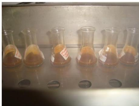
**Figura 12:** Digestión ácida de las muestras de sedimento analizadas
