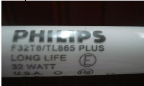
En la Figura 9 no se cumplen las indicaciones mínimas exigidas por el RETILAP, ya que no posee el índice de Rendimiento del Color (IRC), ni el flujo luminoso.
